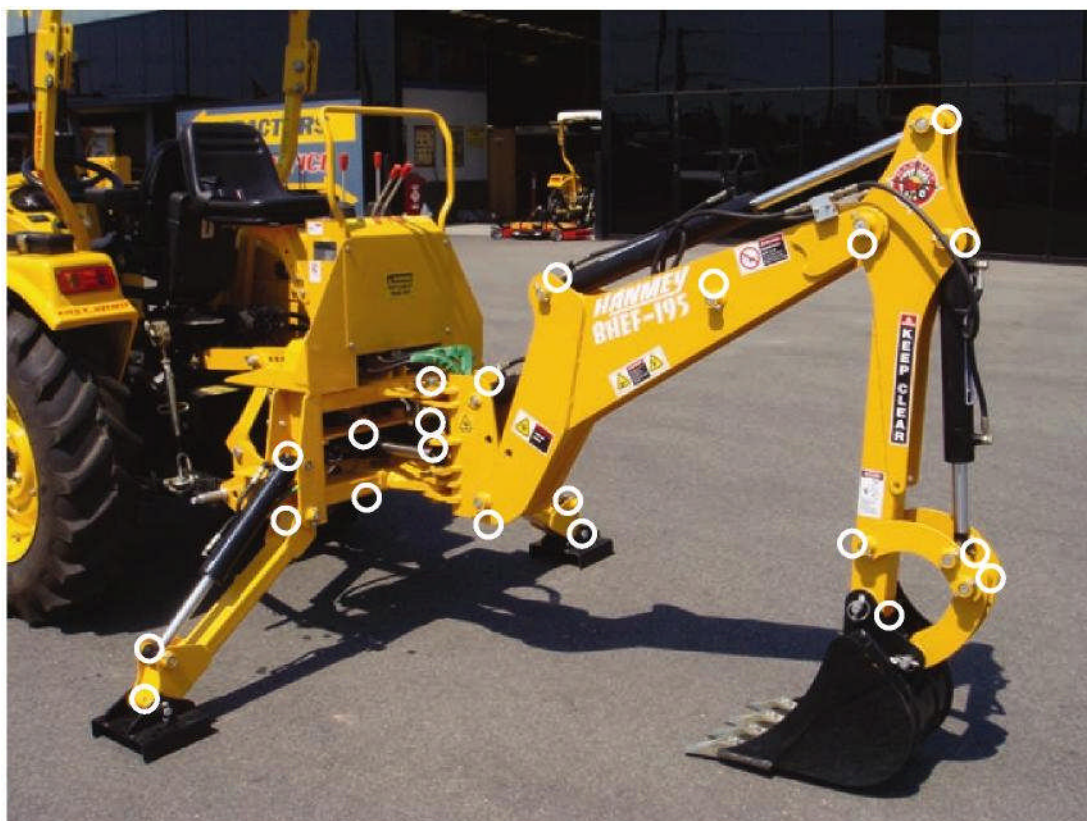
Det finnes totalt 27 smørenipler på BHEF & BHUF-seriene.
